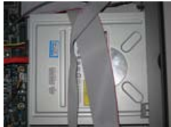
1.1. Ábra: A DVD-író csatlakoztatása
